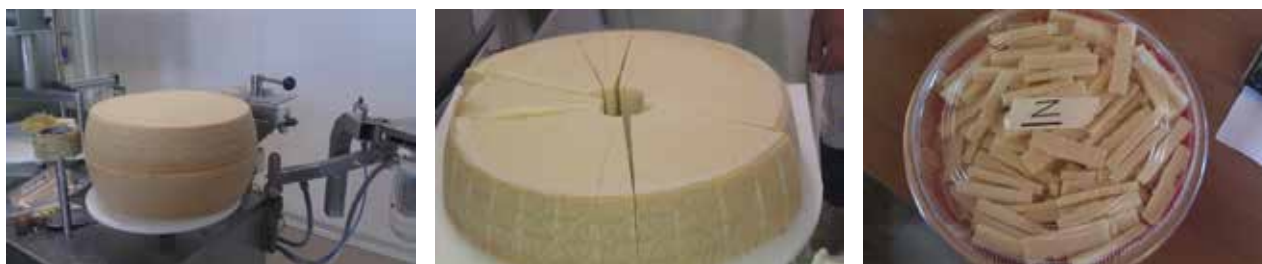
Fig. 5.2.1. Modalità del taglio delle forme mediante macchina
